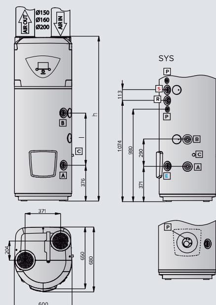
Diámetros conexión conducción aire disponibles de serie (in y out): Ø150 mm, Ø160 mm, Ø200 mm.
